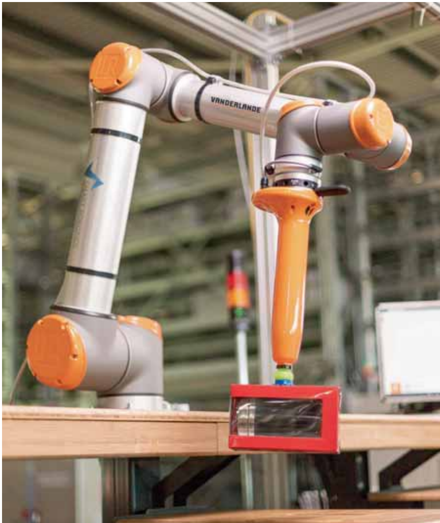
Vanderlande hat einen „Cobot“ entwickelt, der neben menschlichen Bedienern arbeitet
