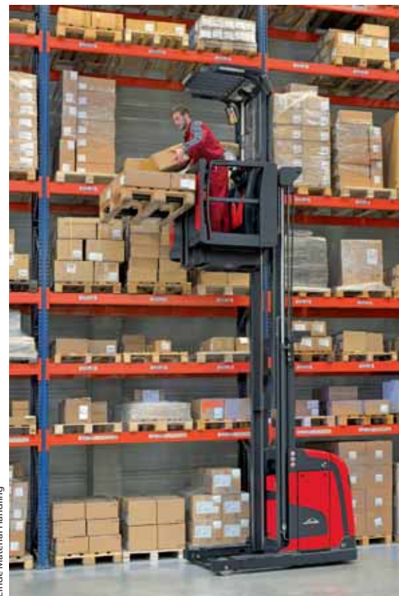
Die modularen Mittelhubkommissionierer von Linde haben Greifhöhen bis zwölf Meter
