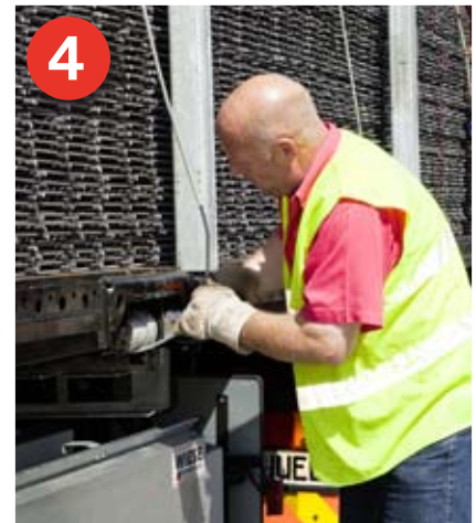
4 Um ein Schwingen der Matten nach oben zu verhindern, wird zusätzlich niedergezurrt. Achtung, nur sichere Winden benutzen!
