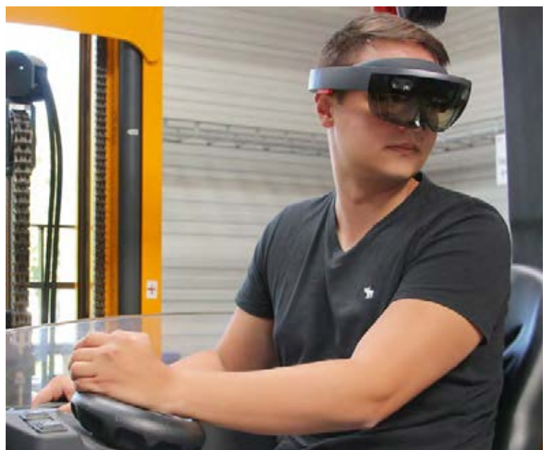
IPH-Projekt „Visier“: Mit der AR-Brille wirkt es, als könne der Staplerfahrer durch Hindernisse hindurchsehen
